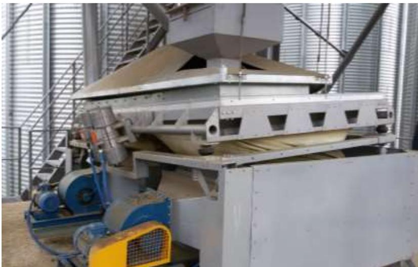
Пневмостол предназначен для очистки семян зерновых культур от трудно выделительных примесей и разделения зерна на фракции по плотности (удельному весу), форме, размерам и свойствам поверхности.
